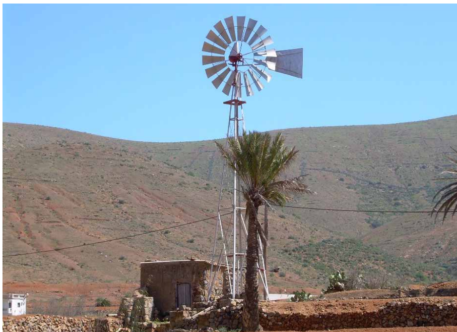
Figura 2.1. Molino de viento para elevación de aguas.
